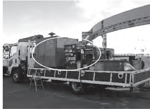
写真一 五 油水分離・高圧洗浄ユニット (○印)
