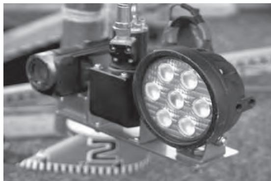
写真—6 回転撮影型カメラ【特許第 6089069 号】
