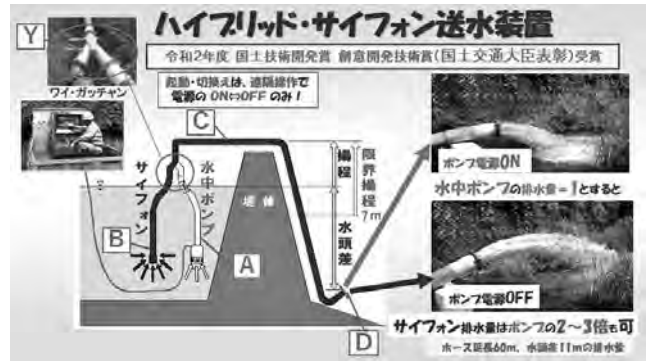
図-1 ハイブリッド・サイフォン送水装置
