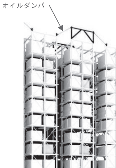
図-2 屋根裏空間を利用した制震構法
