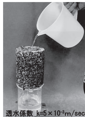
写真-1 透水性改良体
