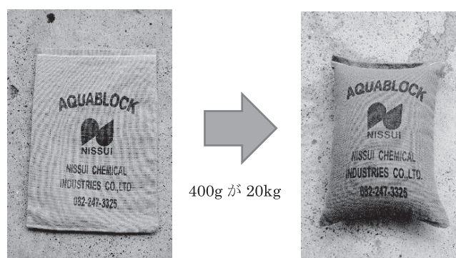
写真—1 吸水前（左）と吸水後（右）
