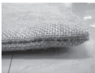
写真—4 内縫い仕上げ
