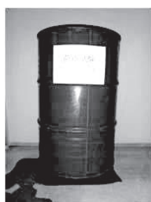
写真—6 荷重試験（荷重200kg）
