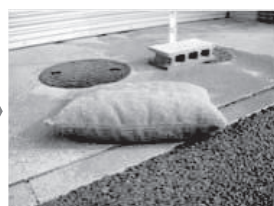
写真—5 落下試験（5.5m）
