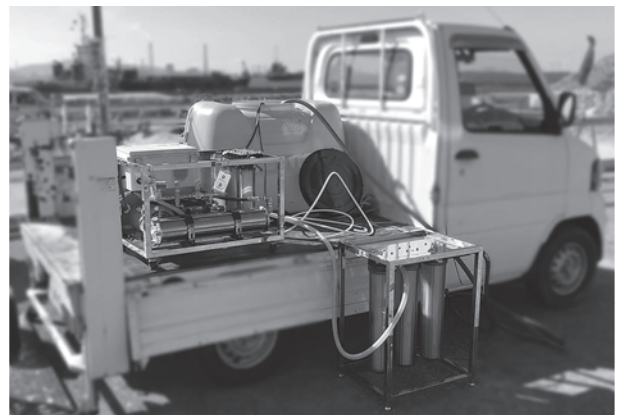
写真-5 軽トラックに搭載した小型海水淡水化装置
