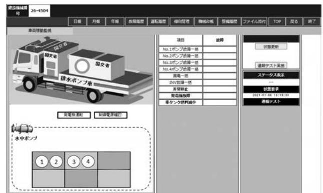
図-6 DSシステム簡易版のモニタ表示例
