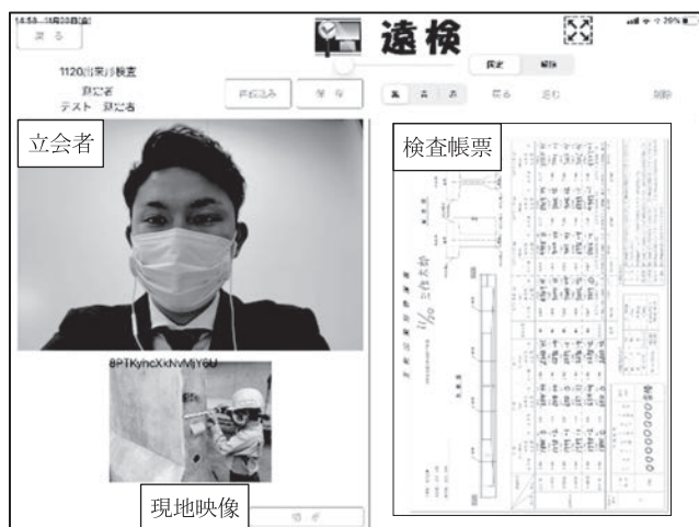
図-1 「遠検」を利用した立会状況（タブレット画面）
