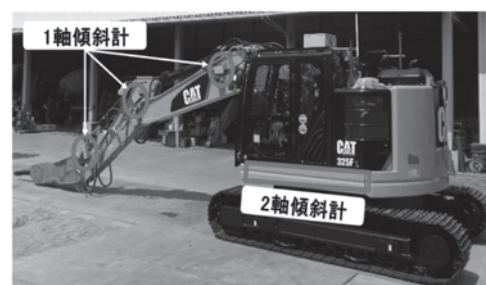
写真-2 油圧ブレイカー各部の傾斜計
