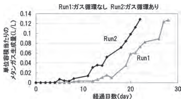
図—4 単位容積当たりのメタンガス生成量の経時変化
