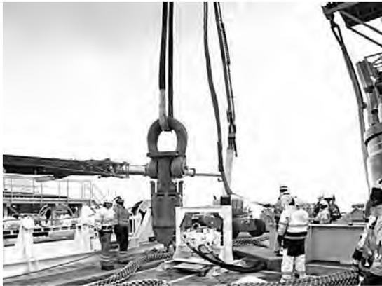
写真—13 汎用型吊り具 作業風景
