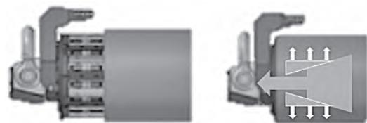
図一1 杭専用吊り具の稼働原理 (1)
