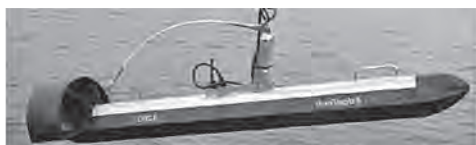
EdgeTech4205 (図-1 中の SSS) 300,600,900kHz のうち 2 周波同時測定 EdgeTech 社 HP より引用
