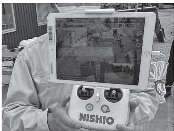
写真-10 ドローンコントローラー+表示画面
