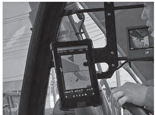
写真-8 運転席のモニター (日立建機純正)
