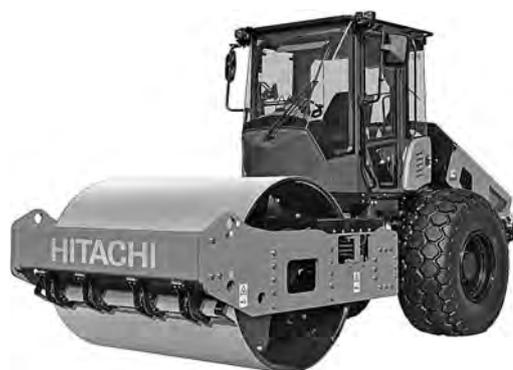
写真-1 日立建機 ZC120S-6 土工用振動ローラ
