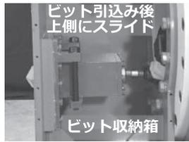
写真一五 旧ビット収納箱引込み
