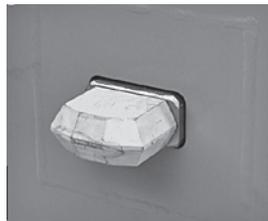
写真一九 新ビット交換完了
