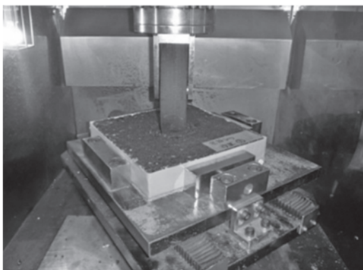
写真一 2 繰り返し表面剥奪試験
