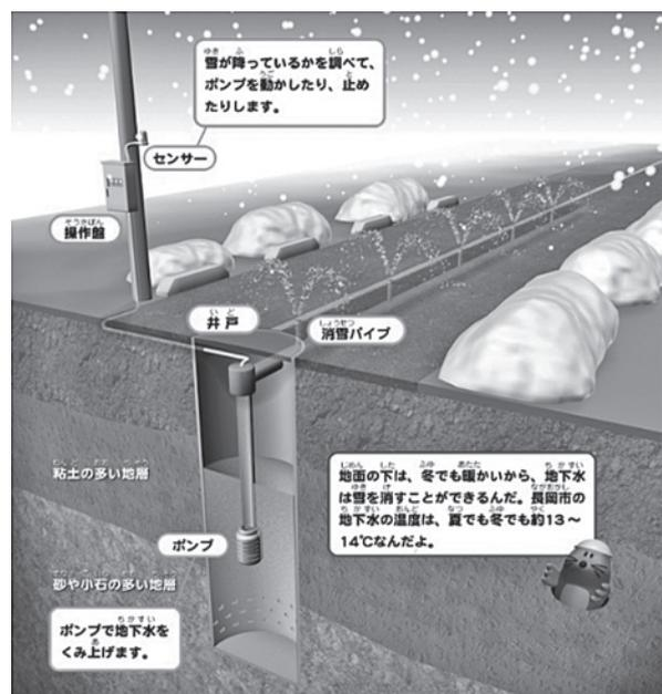
図-1 消雪パイプの仕組み
