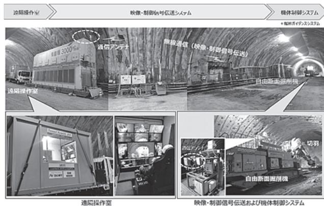
図-1 自由断面掘削機遠隔操作システムの構成
