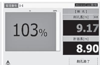
図-3 削孔計測画面
