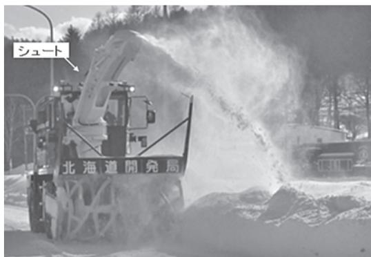
写真一4 投雪作業実験状況
