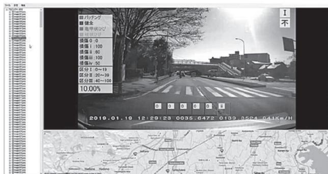
図-4 舗装点検支援システム
