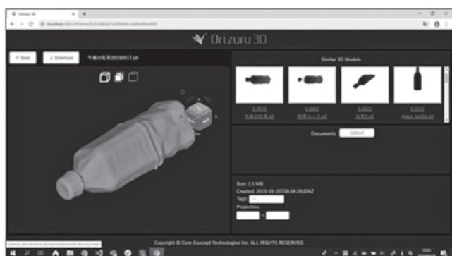
図一4 左側は 3D スキャナーで取ったあるパーツの点群データ／右側は点群データから AI が形状認識し、似たパーツをビッグデータから検出し形状の類似度の高い物から並べたもの
