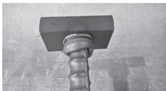
写真一 2 プレート定着型鉄筋
