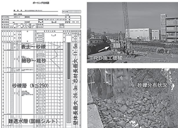
図一 18 土質柱状図と施工・砂礫分布状況
