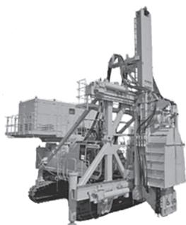
写真—3 TRD III-2型 (鉛直壁)
