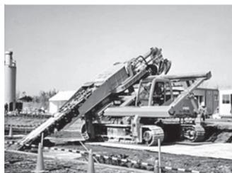
写真—4 TRD I型 (傾斜壁)
