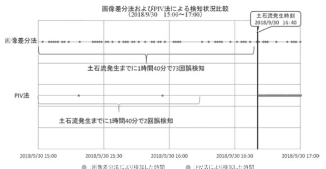
図-7 画像差分法と PIV 手法の検知状況の比較結果
