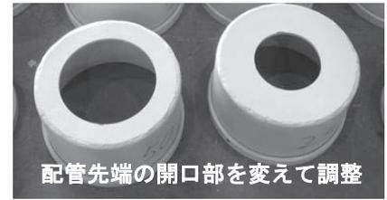
配管先端の開口部を変えて調整
