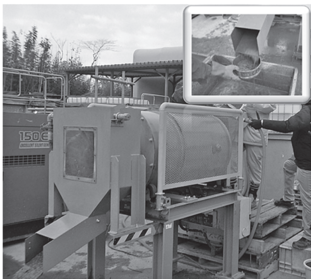
写真一五 ドラムウォッシャー（実験機）と解泥確認状況
