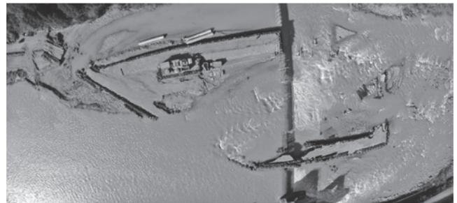
写真—12 仮締切破堤（平成27年12月）
