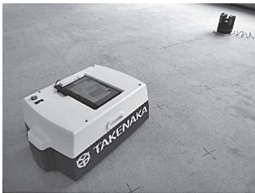
写真-1 墨出しロボットシステムの構成
