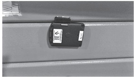
写真一10 稼働率センサー付きビーコン
