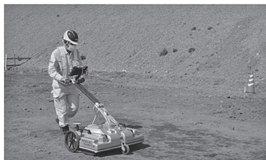
写真三 地中探査の実施状況
