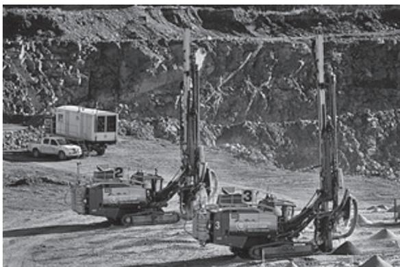
写真一3 白いトレーラーに搭載されたベンチリモートから複数台のせん孔機の実際の操作
