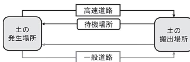
図-1 試行現場の土運搬方法
