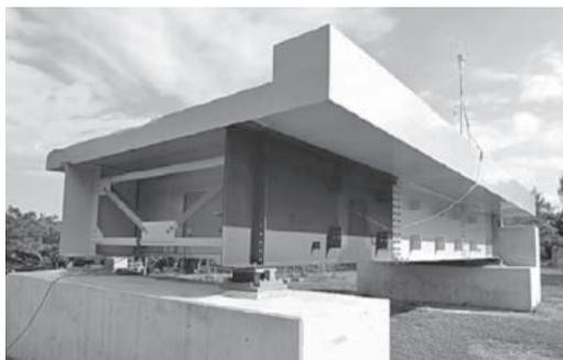
写真-6 実物大実験橋
