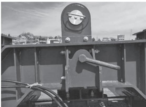
写真-7 吊り天秤のスライド可能な吊りピース
