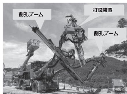
図一 2 ロックボルト専用機機構
