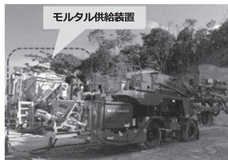
図一 3 モルタル供給装置の搭載
