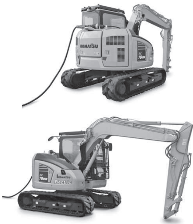
写真-3 有線式電動油圧ショベル「PC78USE-11」
