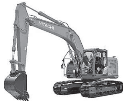
写真二 日立建機 ZX225USR-7 後方小旋回型油圧ショベル
