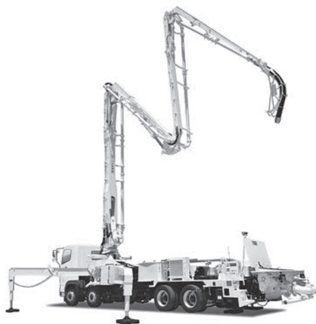
写真一5 極東開発工業 PY140-36A コンクリートポンプ
