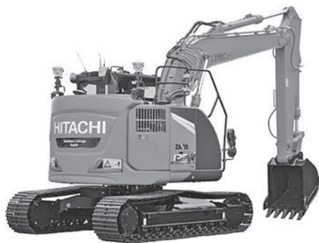
写真一4 日立建機 ZX135USX-7 情報化施工油圧ショベル
