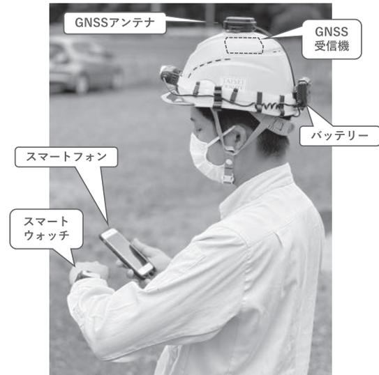
図—9 RTK-GNSSの装備
