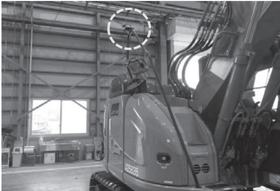
写真—3 カメラの固定方法 (右側面)
