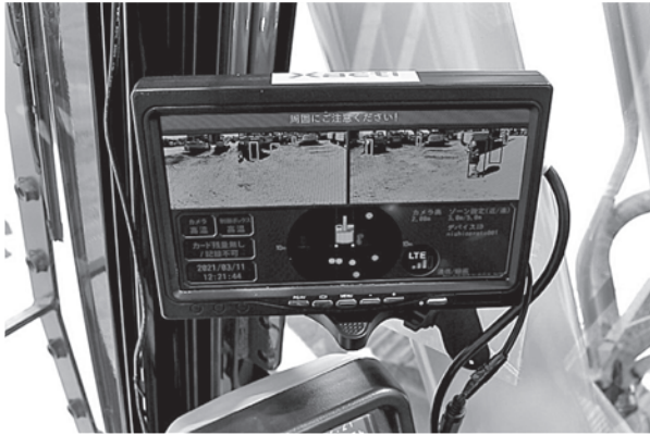
写真一2 運転室内モニター
