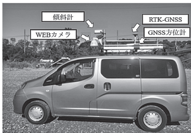
図一3 機材設置状況
