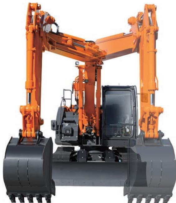
後方超小旋回型油圧ショベル オフセットブーム仕様機
