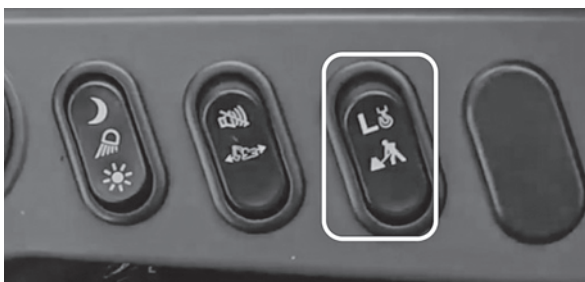
図—12 アームクレーンワンタッチ切替スイッチ
