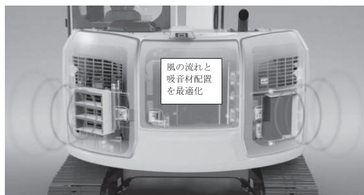
図—8 外装構造変更による騒音低減
