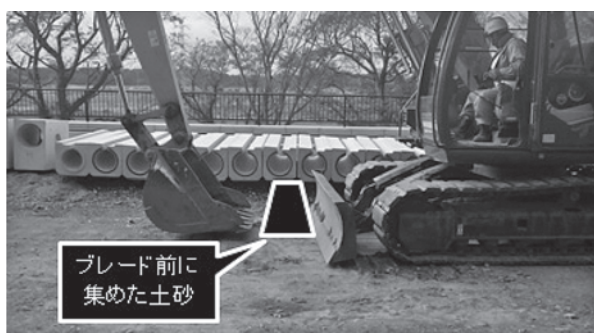
写真-5 オフセット仕様機でブレード前土砂をすくう動作の例
