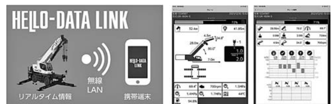
図-6 無線LANによる車両情報表示
