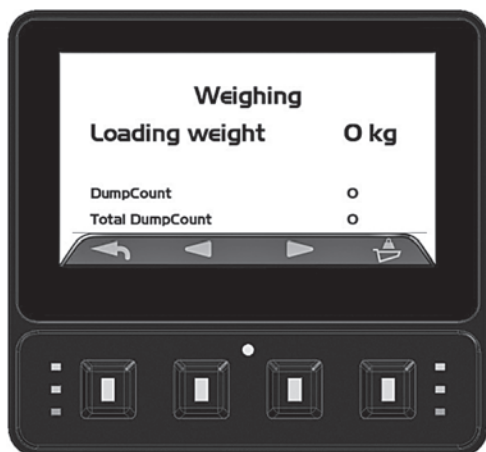
図-5 荷台計量時 モニタディスプレイ画面
