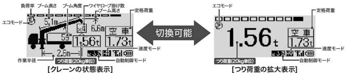
図一七 液晶ラジコンのディスプレイ表示
