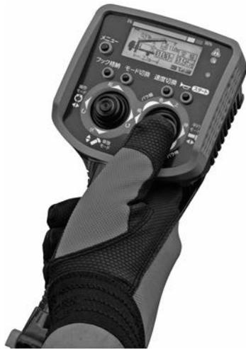
図一六 ジョイスティック式液晶ラジコン
