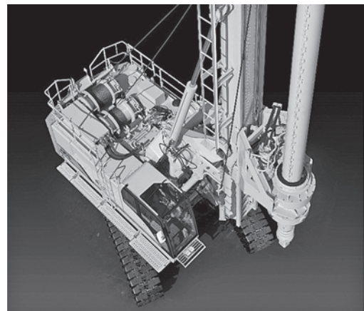
写真-6 ハウス上面ハンドレールおよびキャットウォーク
