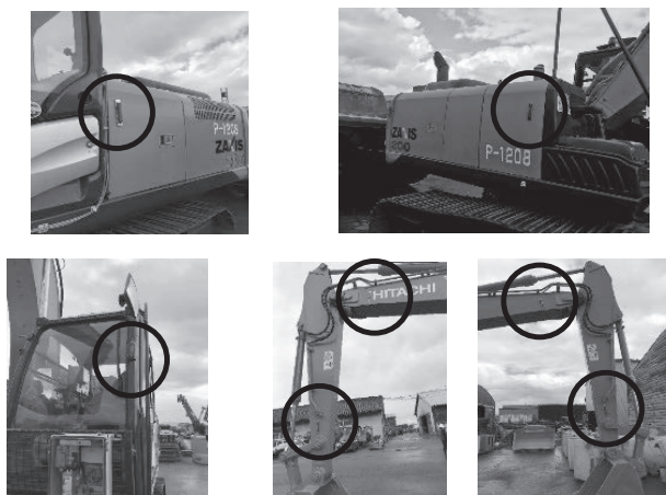
写真-4 RFID タグ (7箇所) のショベル実装事例
