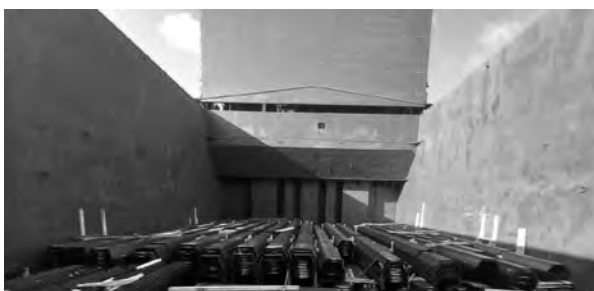
写真-1 船倉での鋼矢板状況
