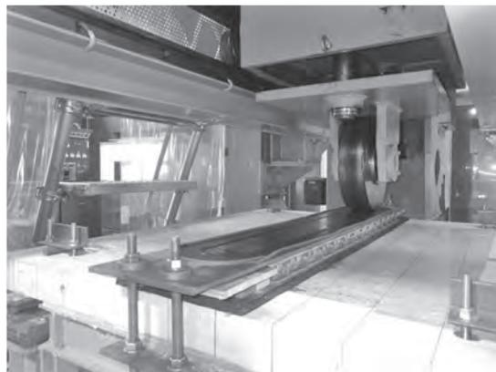
写真—1 小型輪荷重走行試験機
